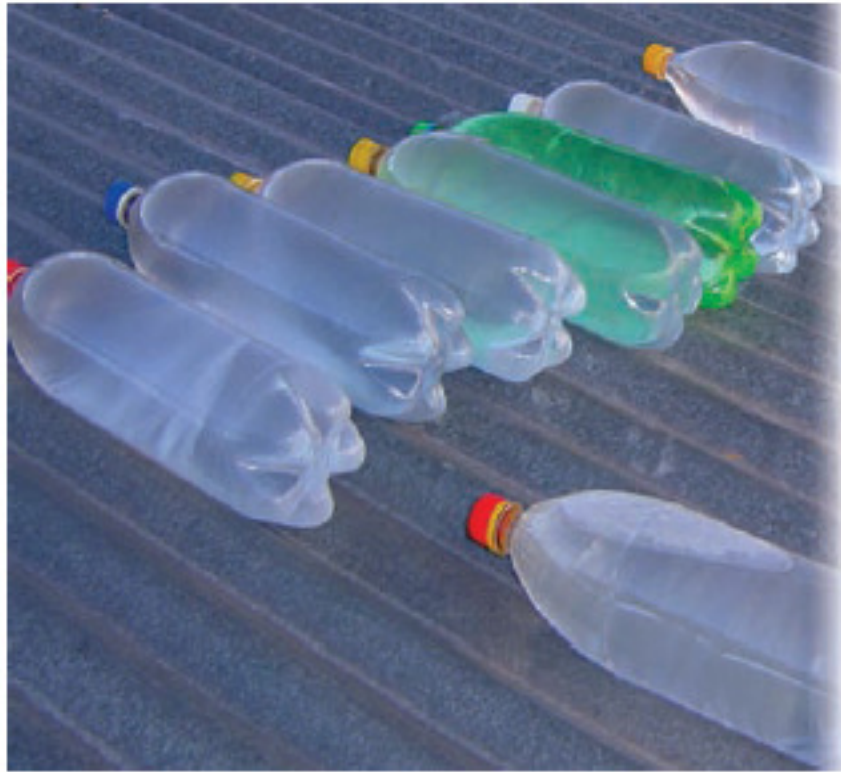
El tipo de botellas influye en la eficiencia de SODIS.
